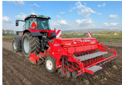
RTK自動操舵とコンビネーションドリル播種作業
