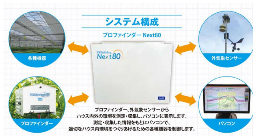
統合環境制御システムを活用
