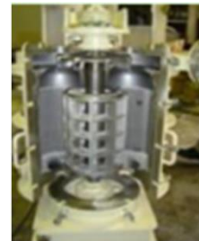
粉碎装置(気流式粉碎装置)
