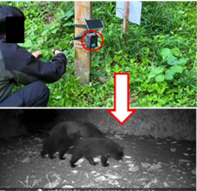
▲管理施設内の監視カメラ設置（事例は、動物などの動きに応じて録画するタイプの監視カメラを設置）
