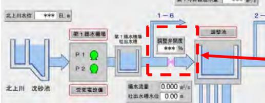
容量の小さい吐水槽ではなく、調整池の水位で運転するように変更。また、吐水槽が溢れないよう調整弁をきめ細やかに制御。
