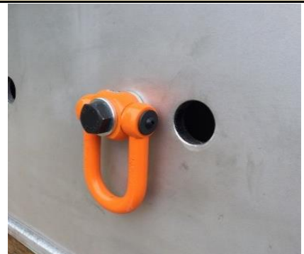
マルチアイボルトを用いた施工
