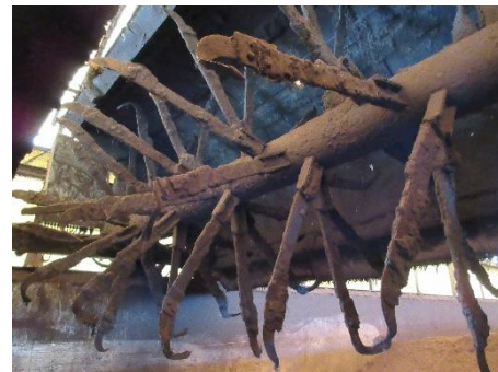
巨大な爪で肥料を攪はんする機械（1日に3回稼働）
