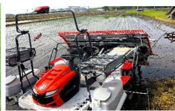
GPS付自動運転田植機 (写真提供：高橋恭平さん)
