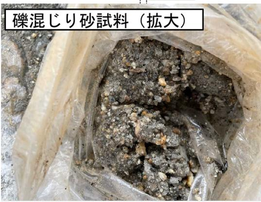
根固め層の下に1.05m (深度7.00m~8.05m) 厚のN値2～4の礫混じり砂を確認。
