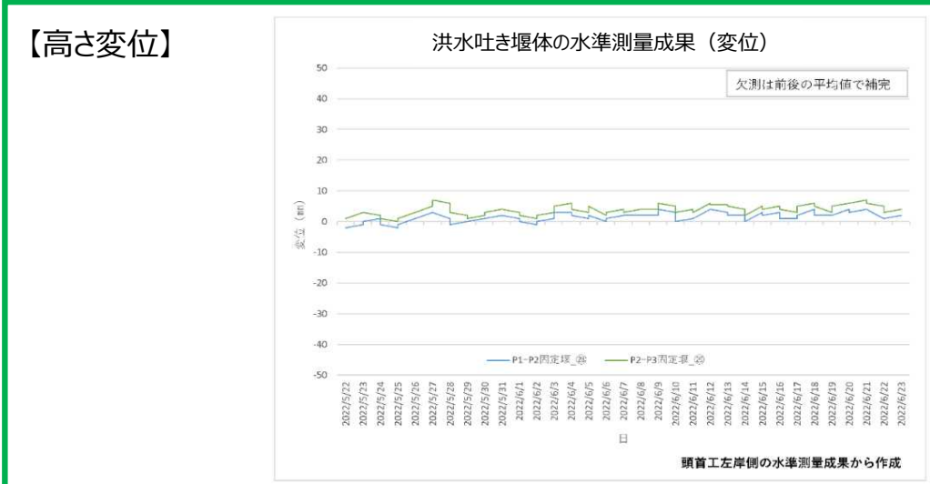
図-4.1 洪水吐き堰体の高さ変位（P1～P2、P2～P3）
