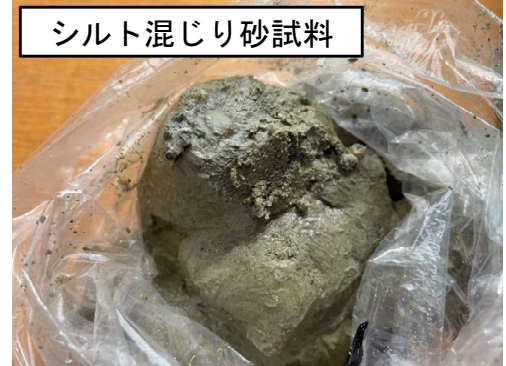
細砂層の下に0.80m (深度9.90～10.70m) のシルト混じり砂を確認。含水量が高く、締まっている。
