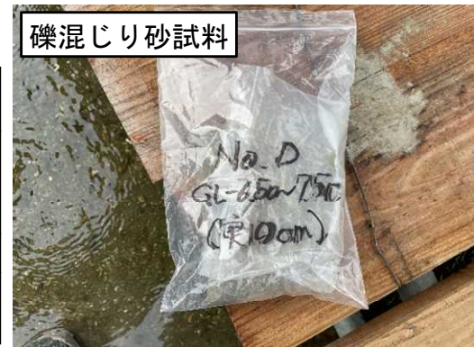
※根固め層は一軸圧縮試験結果 深度6.50～7.50m区間において、試料を採取。採取できた試料は10cm程度。
