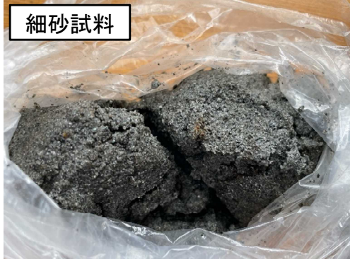
礫混じり砂層の下に1.10m (深度8.80m～9.90m) 厚のN値10の細砂を確認。指圧で崩れる程度。
