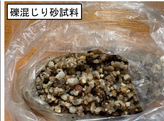
深度6.60～8.80m区間において、試験可能な容量を採取できなかった。礫径5mm程度。
