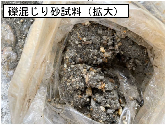
根固め層の下に1.05m (深度7.00m~8.05m) 厚のN値2～4の礫混じり砂を確認。
