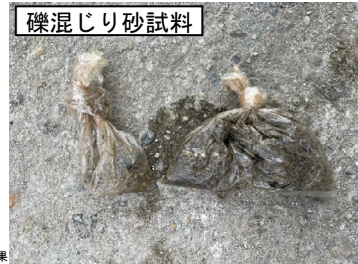
礫混じり砂層において、試験可能な容量を採取できなかった。
