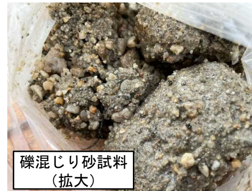
根固め層の下に1.00m（深度6.00m～7.00m）厚のN値12の礫混じり砂を確認。
