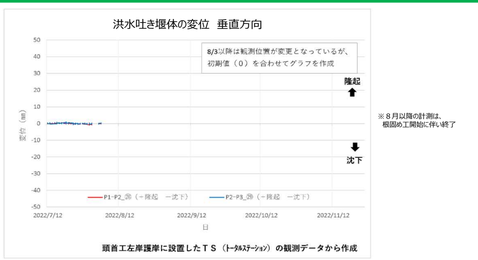
図-4.2 洪水吐き堰体の高さ変位（P1～P2・P2～P3 隆起・沈下）
