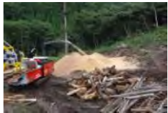
バイオマス燃料を山土場で 効率的に生産する移動式チップー
