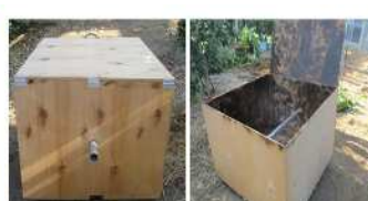
図12. 熱効率を改善した 堆肥発酵熱ヒーター（正面、内部）
