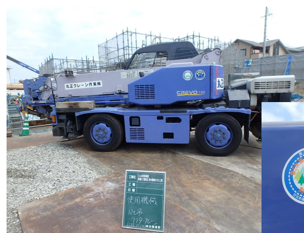
ラフテレーンクレーン
