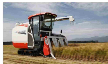
食味・収量測定機能搭載のコンバイン
