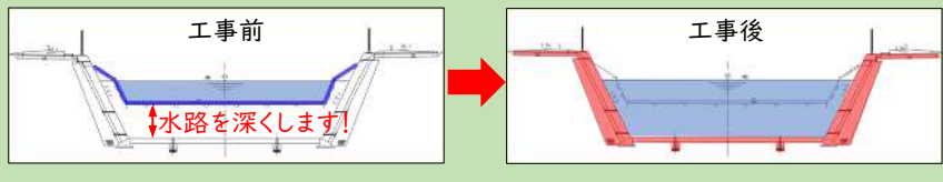
※小牧市東田中地内の工事
