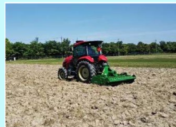
農業者の搭乗なしに農作業をするオートトラクタの実証
