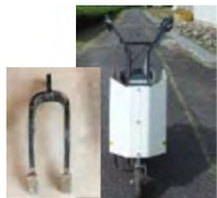
爪先を改良したクランクカルチ機
