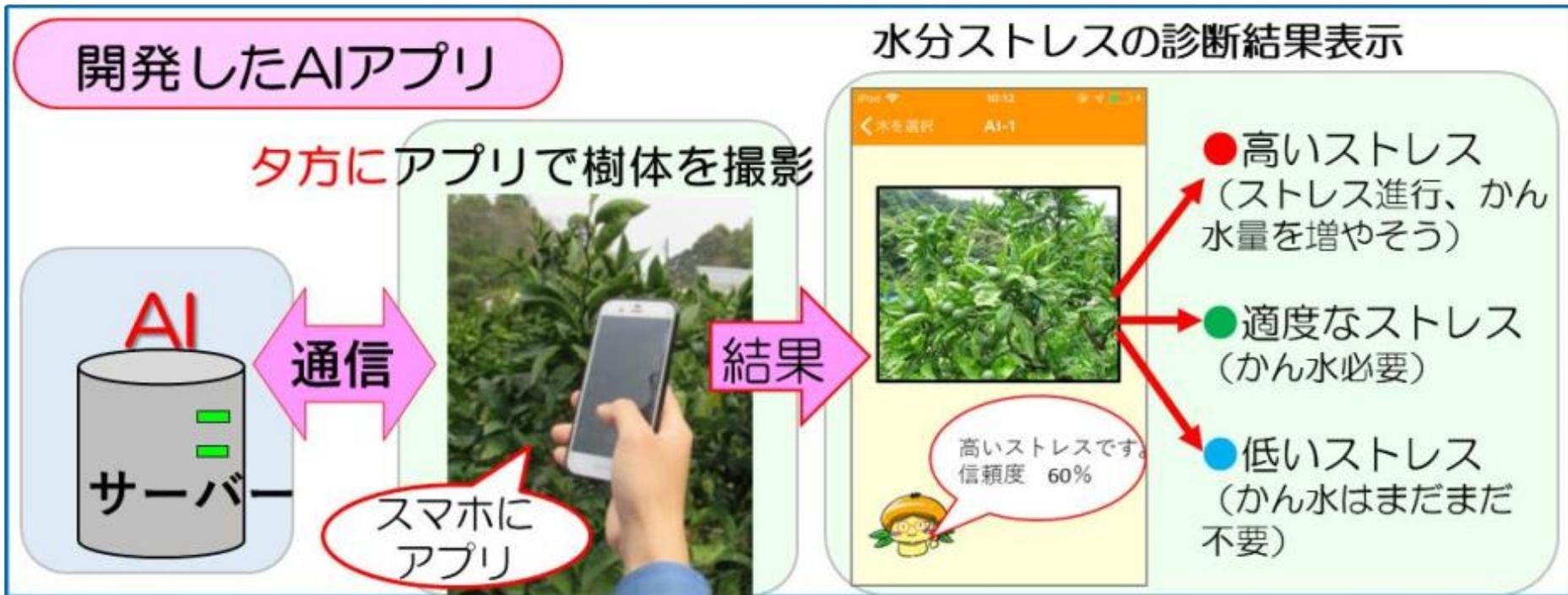
スマホアプリで時刻に樹体画像を撮影、水分ストレスの強さをAIが診断し、結果に応じて手動でタイマー灌水を実施する。
