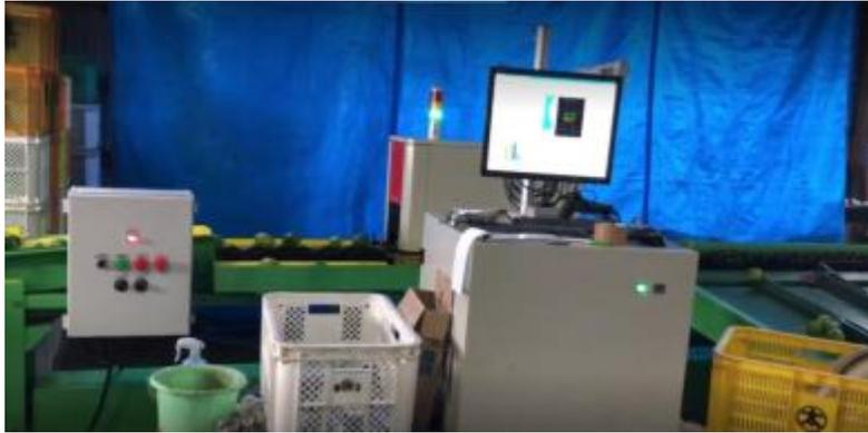
プレ選果機で、30~50%の作業時間を削減。さらに、外観の阻害要因をAIが判断し、次作以降の果実品質向上につなげる
