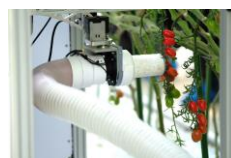
吸引型ミニトマト収穫ロボット「T7」（自社開発）
