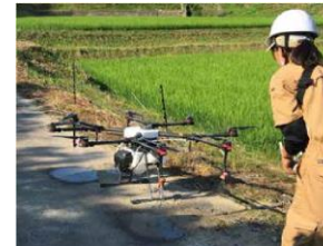
オペレーター等によるドローン散布
