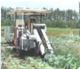
自動収穫機での収穫に失敗したキャベツ
