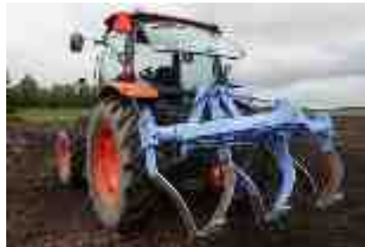
カットブレーカー
