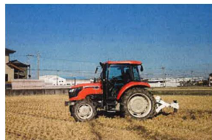
〔導入した自動操舵システム付トラクターを用いたサブソイラによる心土破碎〕
