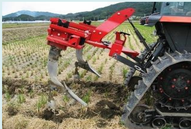
小麦ほ場の弾丸暗渠の施工
