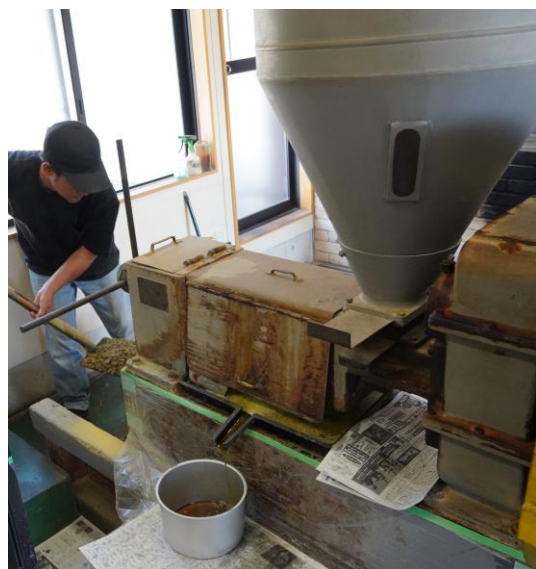
先代からのスクリー型搾油機を使い、じっくり、丁寧に圧搾
