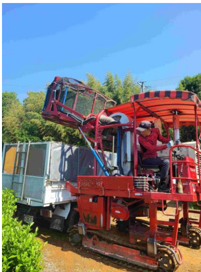
コンテナ式乗用摘採機で刈った茶葉をコンテナトラックに移動
